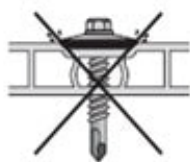
Рисунок 13а НЕВЕРНО! перетянут саморез
